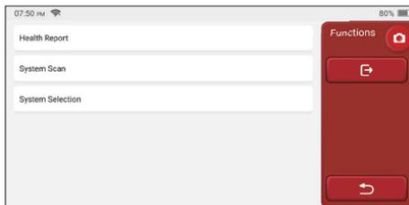
A. Rapport sur l'état: ce mode permet de vérifier rapidement le véhicule et d'afficher le rapport de l'état du véhicule (il n'est disponible que lorsque le logiciel de diagnostic prend en charge cette fonction). Après avoir cliqué sur «test rapide», le système commence à numériser le DTC respectivement et affiche le résultat.
